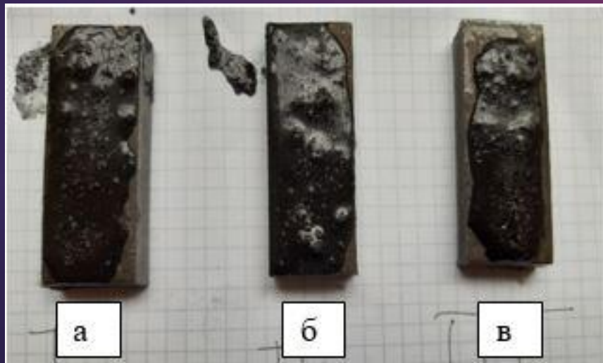
Зразки з нанесеними суспензіями до просушки
