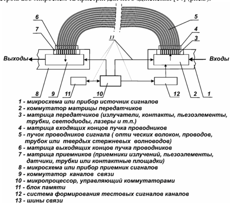
Рис.3. Спосіб з'єднання, що самовідновлюється багатоконтактних пристроїв або мікросхем та пристрій для його здійснення [14]
