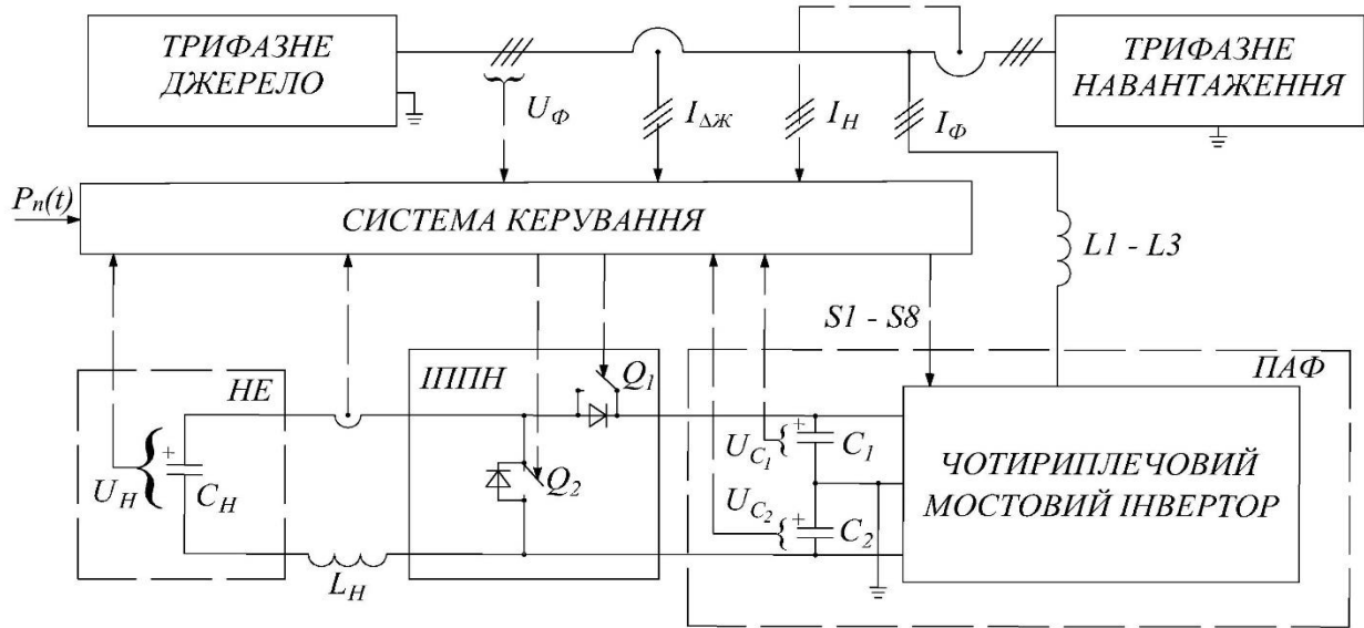
Рисунок 9 – Структурна схема фільтраційної системи з додатковою системою накопичення енергії та системою управління та регулювання
