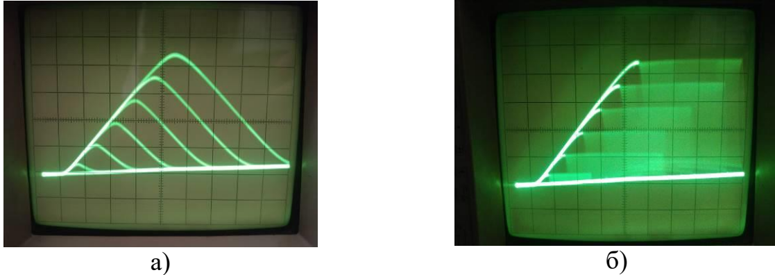
Рисунок 4 – Статична (а) та динамічна (б) ВАХ частотного перетворювача на двох біполярних та польовому транзисторах (по вертикальній вісі одна поділка – 2 мА, по горизонтальній вісі – 2 В)
