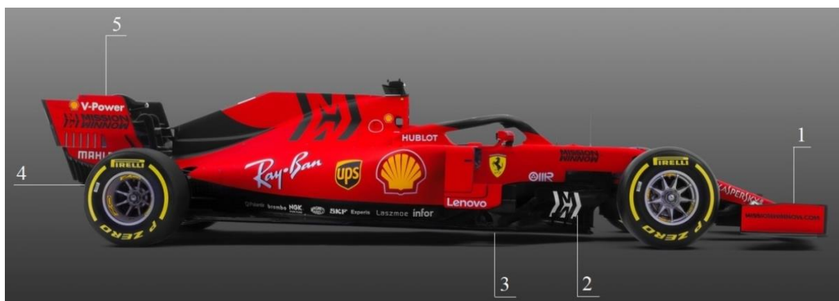
1 - переднє антикрило; 2 - поворотні лопаті; 3 – днище; 4 – дифузор; 5 - заднє антикрило
