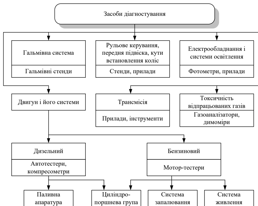
Рисунок 2 – Класифікація обладнання для діагностування автомобілів
