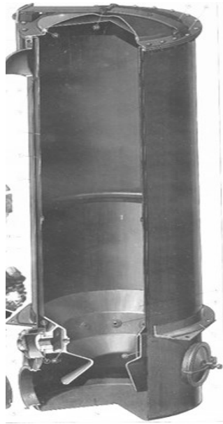
Fig. 4.11. Car gas generator
