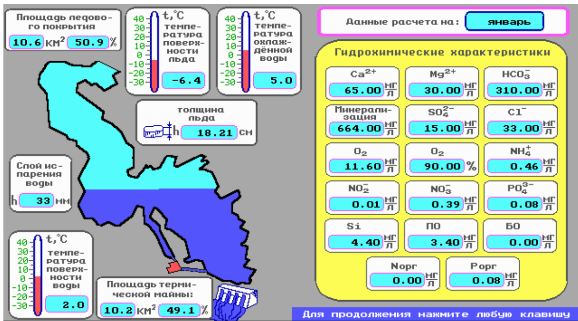
Рис. 2. Схема водосховища та результати розрахунку гідрологічного режиму водосховища ТЕС
