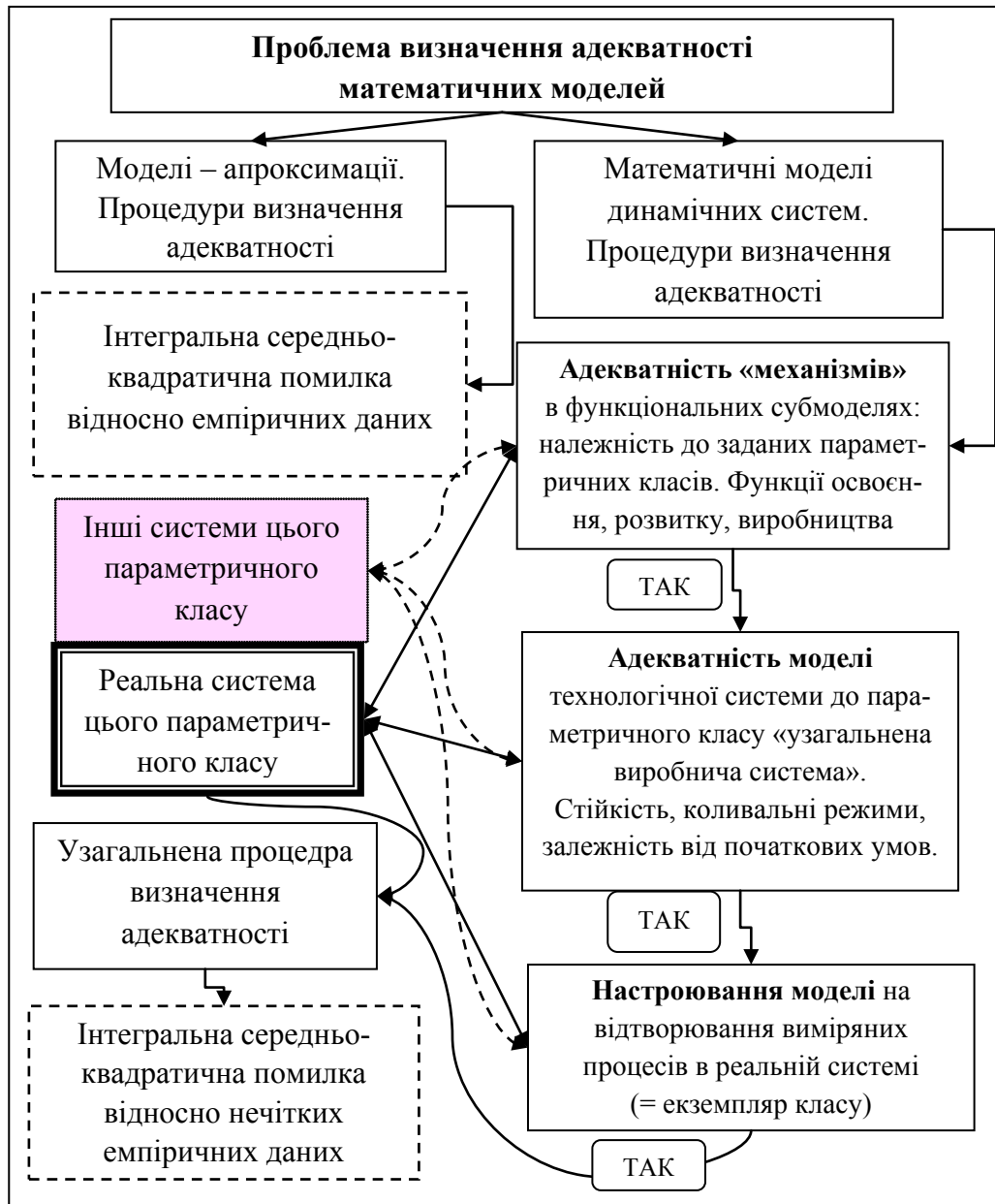
Рисунок 5.20 – Схема процедур встановлення адекватності моделі розвитку
