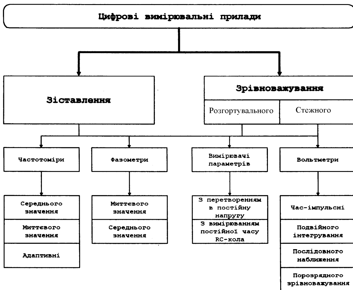
Рисунок 3 - Класифікація цифрових вимірювальних приладів
