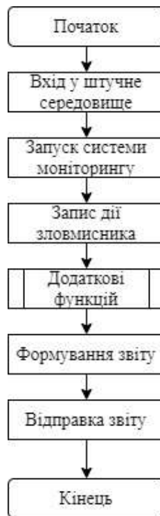
Рисунок 1 – Блок-схема роботи штучного середовища.
