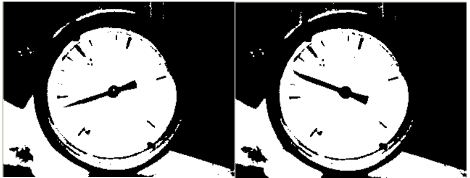
Рис. 1. Фотографії приладу після адаптивної порогової обробки а) зображення в початковому положенні стрілки; б) зображення на конкретному значенні
