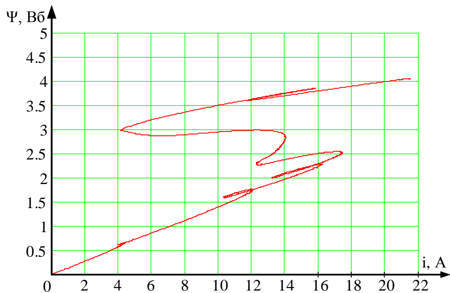
Рисунок 4.14 – Вебер-амперна характеристика обмотки вимкнення електромагніту вакуумного вимикача
