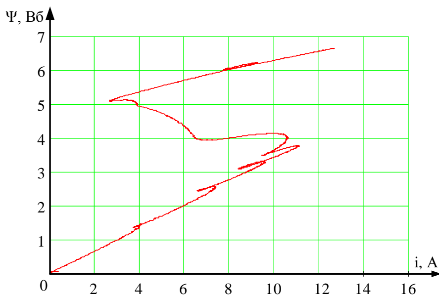
Рисунок 4.15 – Вебер-амперна характеристика обмотки ввімкнення електромагніту вакуумного вимикача
