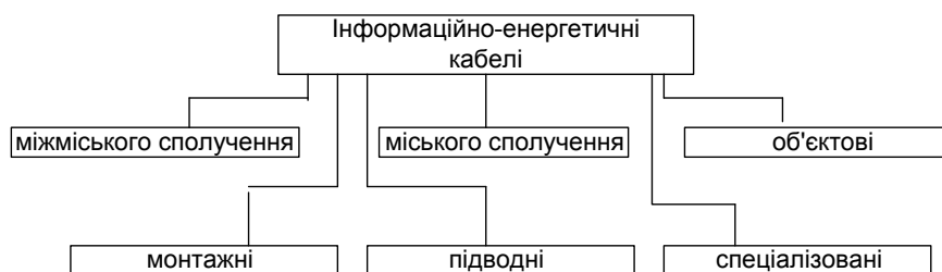
Рис.4. Класифікація інформаційно-енергетичних кабелів по цільовому призначенню
