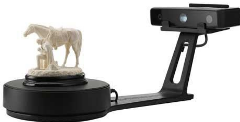
Рис. 1 – Сканування моделі компактним сканером
