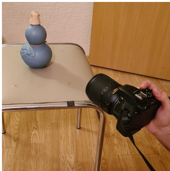
Рис. 10 – Зйомка побутовим фотоапаратом для отримання моделі
