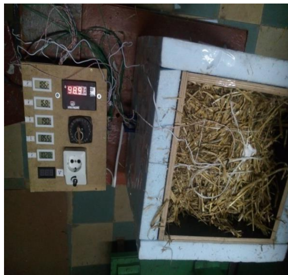
Рисунок 2.9 – Реалізація: БАРТ(зліва) та дослідний зразок спресованої соломи, що розміщено в корпусі установки (справа)
