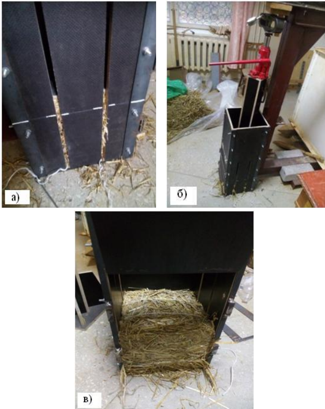
Рисунок 2.11 - Процес пресування солом'яних тюків: а) відмітка потрібної висоти тюка на корпусі установки; б) пресування з передачею зусилля через домкрат та опорну балку; в) виймання готового зразка тюка після завершення пресування
