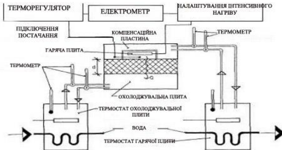
Рисунок 2.4 - Принципова схема вимірювального комплексу визначення теплопровідності методом термічної дифузії
