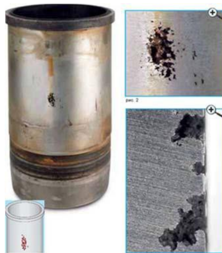
Рисунок 4.1 – Дефекти гільзи блока циліндрів
