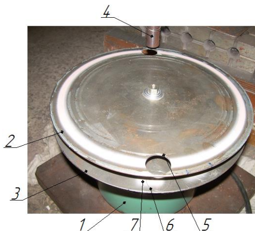
Рисунок 4.5 – Загальний вигляд установки для визначення швидкості руху порошкових частинок:
