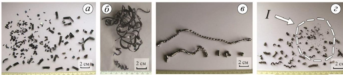
Рис. 1. Стружки утворенні при точінні сталі 38ХНЗМФА на сухо (200 об/хв) після: у стані поставки – а; ковки (технологічна операція - обдирка) – б; термообробки – в; тривалої експлуатації в у водневовмісному середовищі – з (дрібна «крихка» стружка - I).
