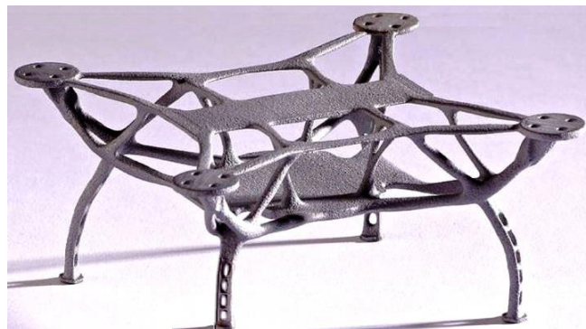
Рис. 2 – Литий каркас для міні-дрона за 3D друкованою моделлю
