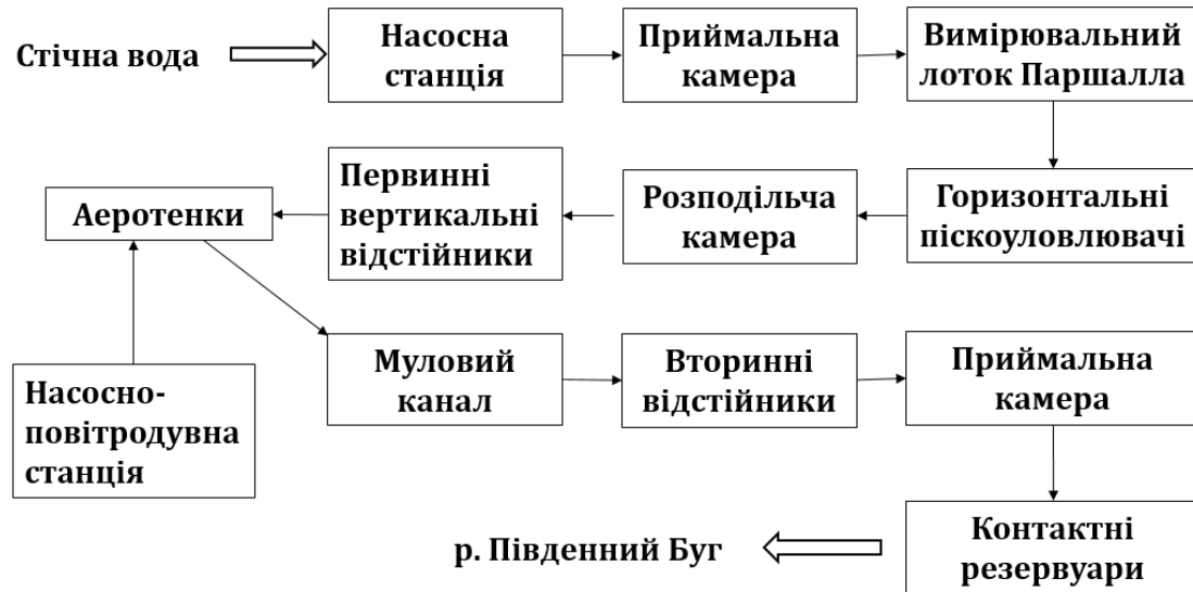
Рис. 2 - Схема технологічного процесу очищення стічних вод
