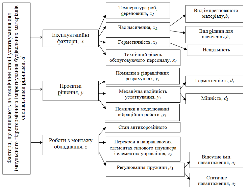
Рисунок 1 – Класифікація факторів, що впливають на технічний стан устаткування для імпульсного гідротермічного імпрегнування будівельних виробів
