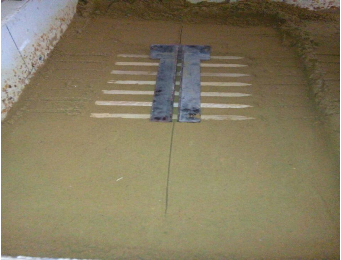
Рисунок 2 Занурення паль горизонтально в ґрунт з кроком 3d
