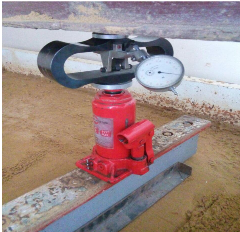
Рисунок 5. Встановлення моделі стрічкового фундаменту у лотку і системи завантаження для її моделювання роботи
