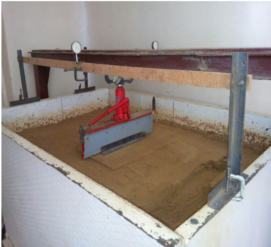
Рисунок 6. Влаштування системи прогиномірів для вимірювання переміщення
