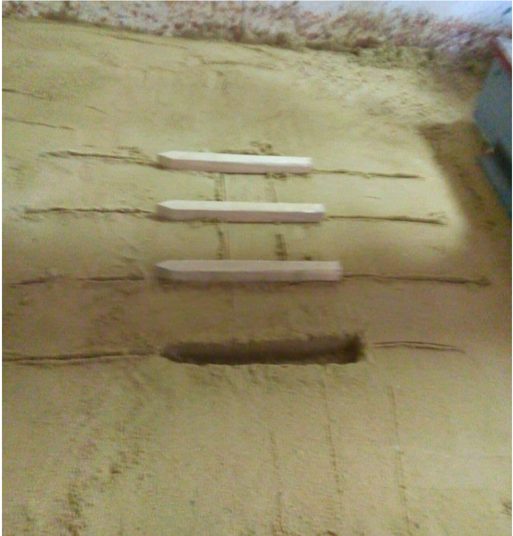
Рисунок 1. Занурення паль горизонтально в ґрунт з кроком 6d
