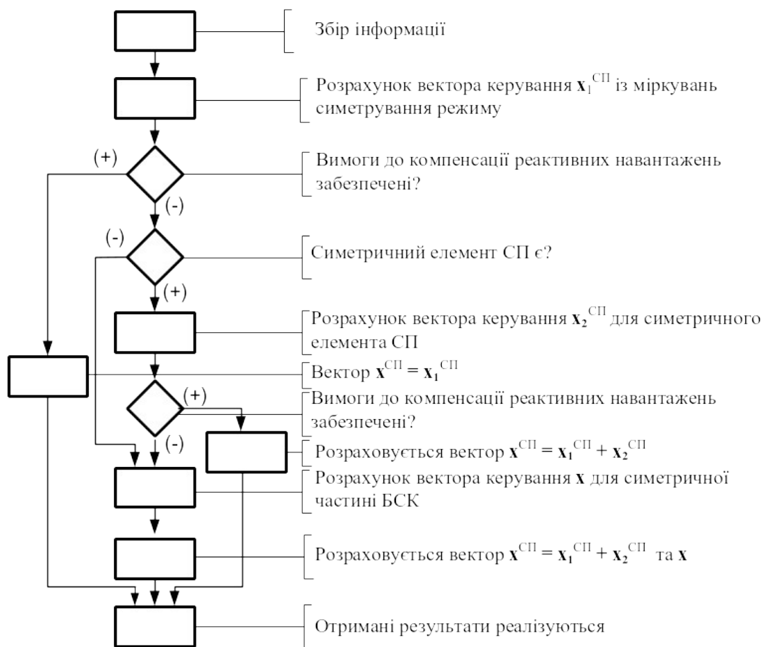
Рисунок – Блок-схема алгоритму розрахунку рішення з оптимального симетрування електричного режиму та компенсації реактивних навантажень
