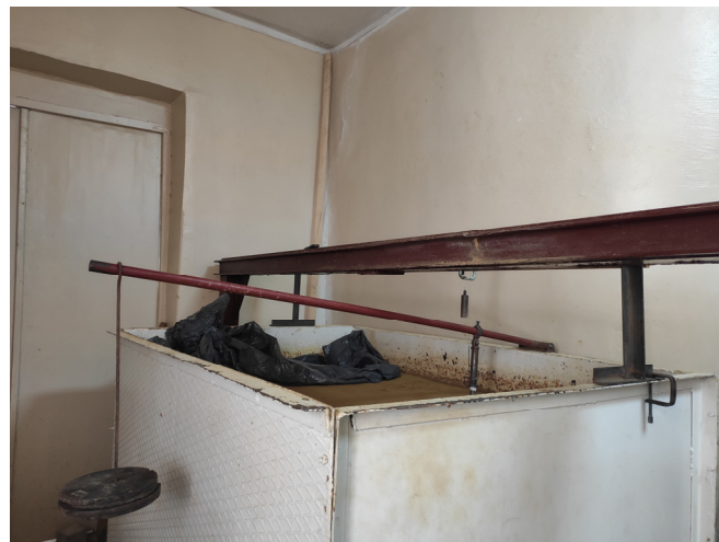
Рис. 2.39 – Випробування одиночної палі в лотку
