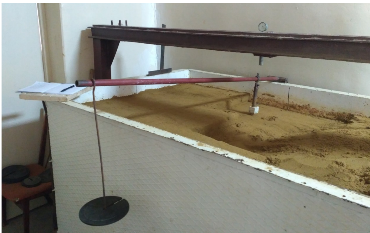
Рис. 2.6 – Процес випробування одиночної пиль в лотку
