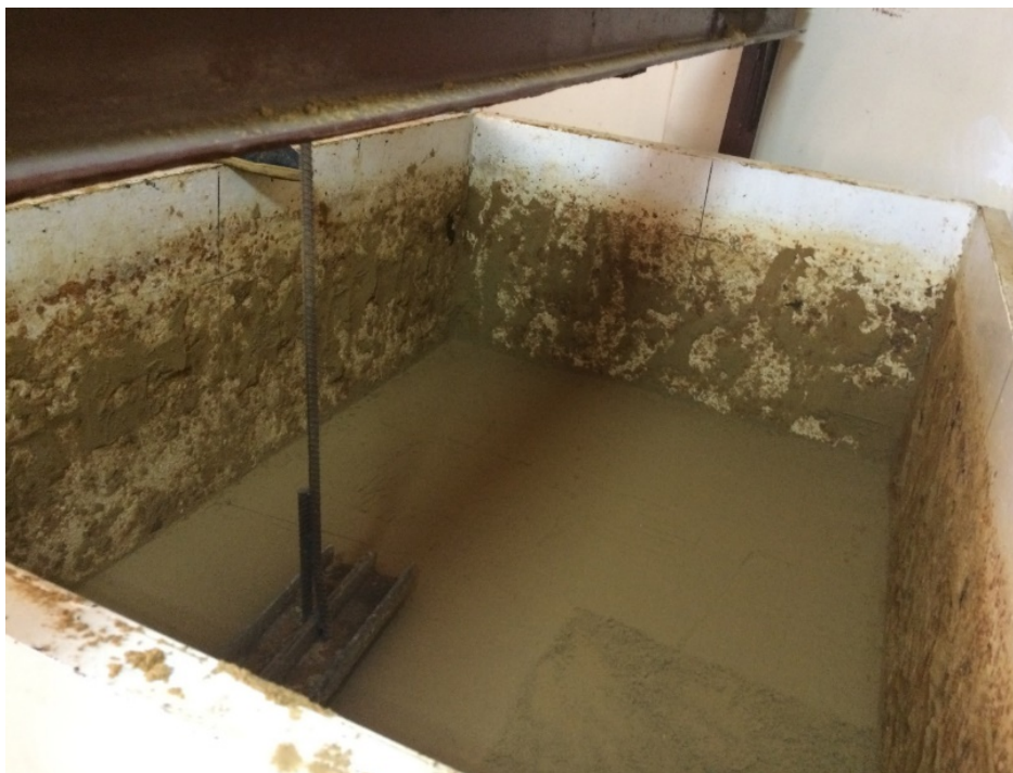
Рис. 2.1 – Лоток з ґрунтовою основою під фундамент з пристроєм для ущільнення ґрунту
