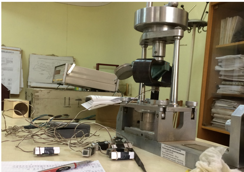
Рис. 2.4 – Пристрій для тарирування датчиків
