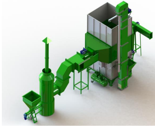
Рисунок 2 – Надрукована на 3D принтері модель вертикальної зерносушильної машини
