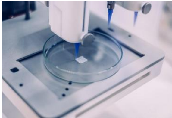
Рисунок 1 - Процес біодруку в чашці Петрі.
