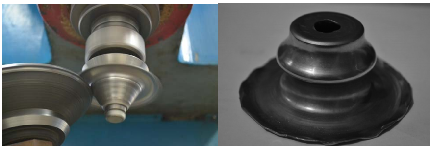
Рис. 5.16. Процес ротaційної витяжки та заготовка складної геометричної форми отримана ротaційною витяжкою
