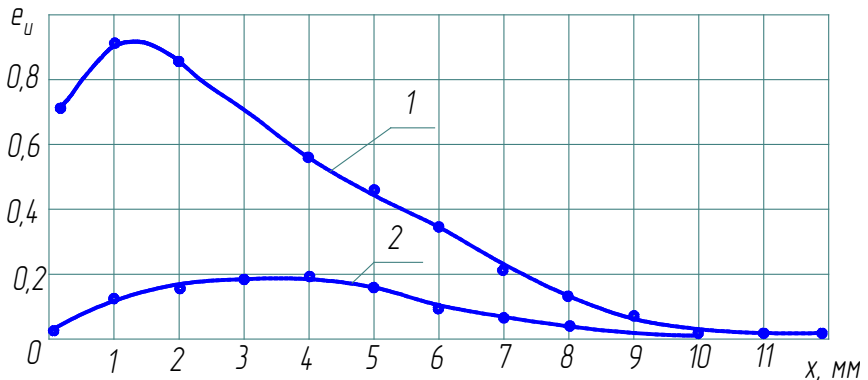
Рис. 2.26. Розподіл накопиченої деформації по глибині поверхнього шару (1 - d=12,5, 2 - d=50, P=125 кН)
