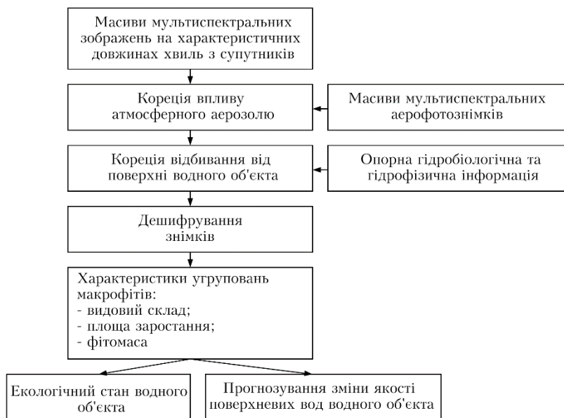
Рис. 6.13. Структурна схема трирівневого оптичного контролю екологічного стану водних об'єктів за характеристиками макрофітів
