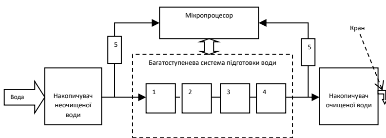
Рис. 3.11. Блок-схема установки для очищення питної води: 1 – фільтр попереднього механічного очищення; 2 – вузол сорбції з активним вугіллям; 3 – мембранний вузол зворотного осмосу; 4 – джерело ультрафіолетового випромінювання; 5 – сенсор електропровідності
