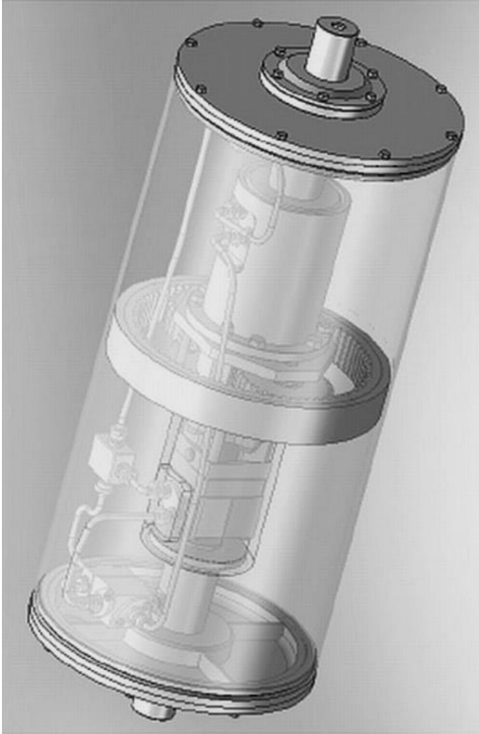
Рисунок 6.5 – Привід з пристроєм керування на основі двокаскадного клапана непрямої дії
