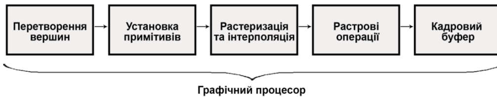
Рис.4 – 3D конвеєр другого покоління
