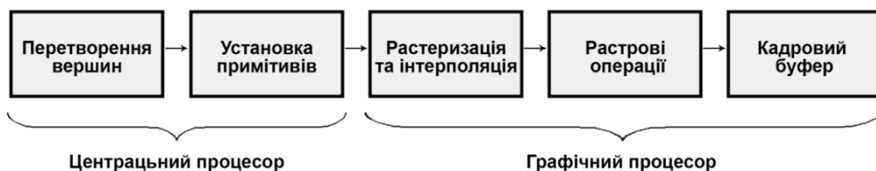
Рис.3 – 3D конвеєр першого покоління
