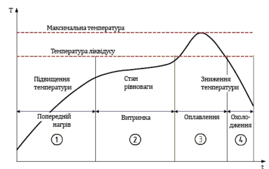
Рис. 1. Типовий температурний профіль пайки
