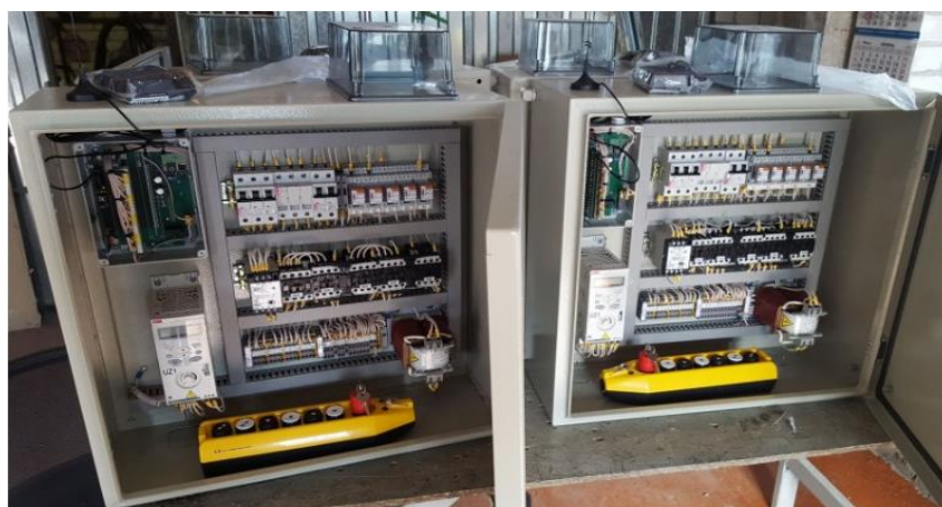
Рис. 1 - Система дистанційного керування краном
