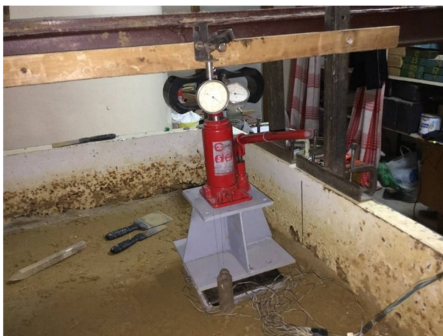
Рис. 3 – Модель пального фундаменту перед випробуванням
