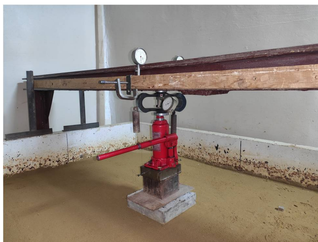
Рис. 4 – Модель випробування плити ростверку
