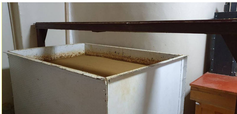
Рис. 2 - Лоток з ґрунтовою основою під фундамент
