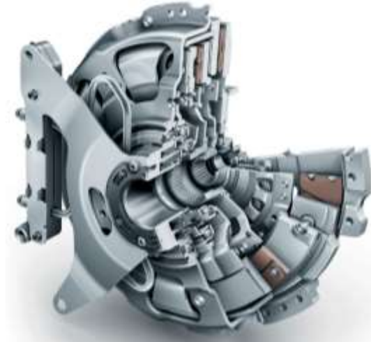
Рисунок 1 – Загальний вигляд подвійного (здвоєного) зчеплення сухого типу
