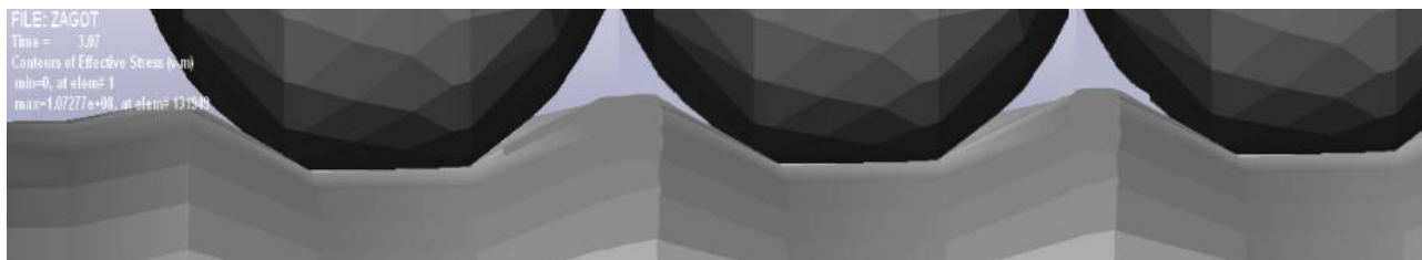
Рис.2. Зони деформування в перерізі деталі
