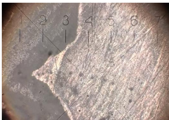
Рисунок 1 – Вимірювання мікротвердості зразка
