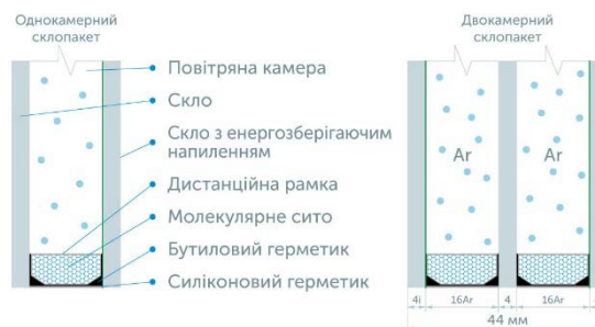
Рис. 5. Детальний опис будови енергоефективного склопакета
