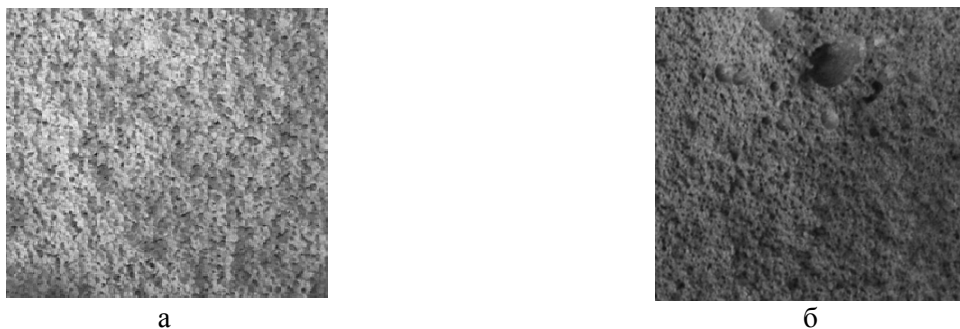
Рис. 2. Фотофіксація експериментальних зразків: а – експериментальний зразок виготовлений традиційним методом; б – експериментальний зразок виготовлений методом аерування пінобетонної суміші
