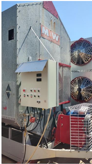
Рис. 1. Виконаний монтаж: а) зовнішній вигляд сушарки; б) щит керування
