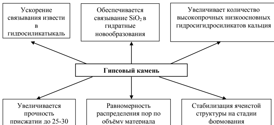
Рис. 4. Влияние гипса на технологические параметры производства и свойства автоклавного газобетона
