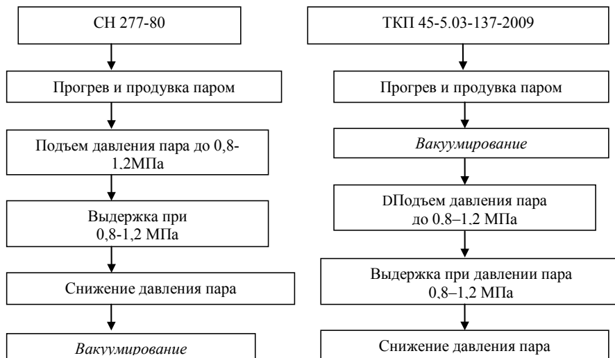
Рис. 2. Сравнительная схема режимов автоклавной обработки
