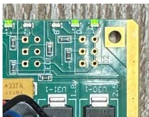
Рисунок 3 – Працюючий індикатор прийому радіосигналу «С» Результати роботи калібрувального ПЗ наведено на рисунку 4.
