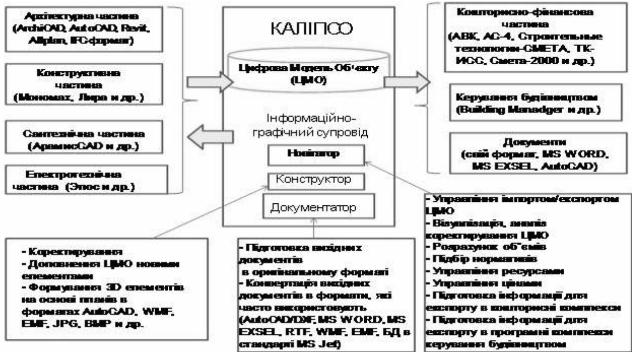
Рис. 2. Схема наповнення та функціонування інтегрованої лінії проектування «КАЛИПСО»
