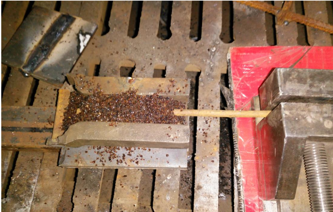
Рис.1. Наплавлення лежачим електродом під шаром флюсу
