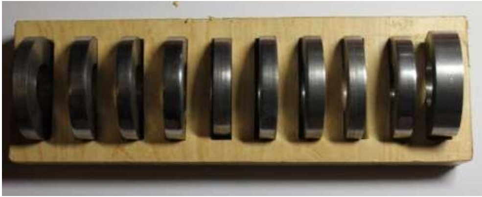
Рис. 2 – Отримані заготовки із сталі 10X17H13M2T
