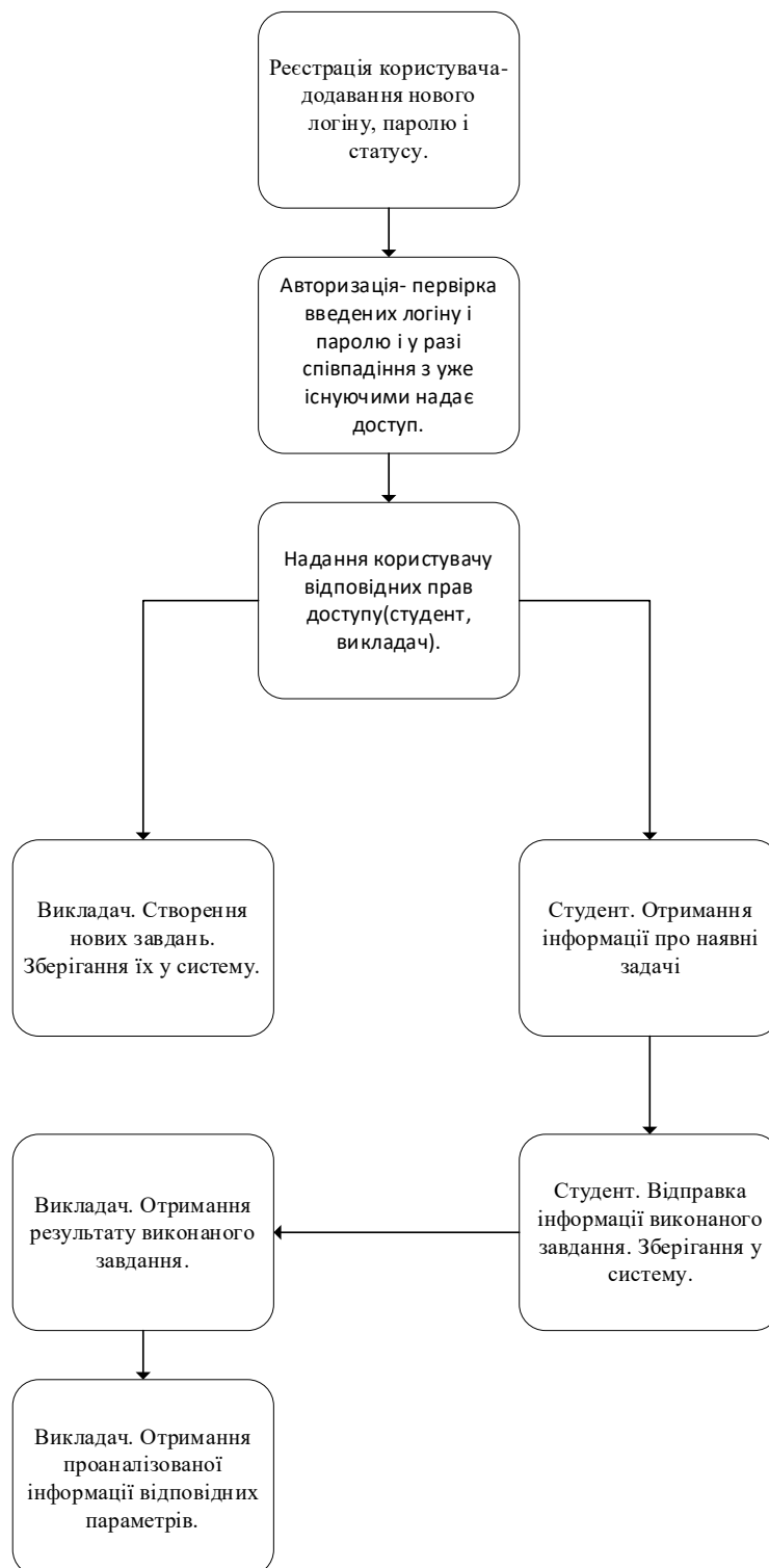
Рис. 1 Структура підсистеми організації передачі інформації
