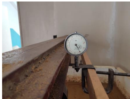
Рис. 2 – Кріплення прогиноміру до балки реперної системи, закріпленої на стінках лотка
