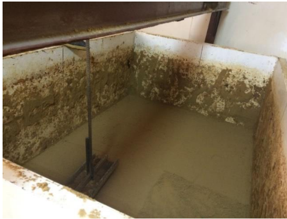
Рис. 1 – Лоток з ґрунтовою основою під фундамент з трамбівкою для ущільнення ґрунту
