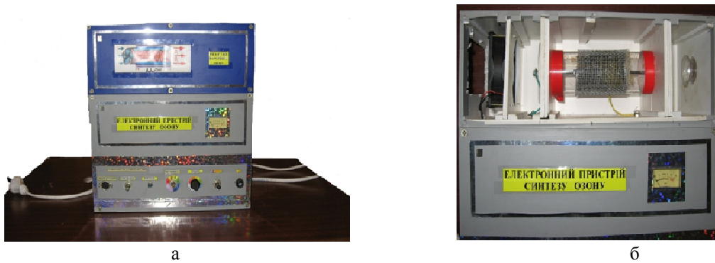
Рис. 2. Електронний пристрій синтезу озону: а – загальний вигляд; б – робоча камера синтезу озону
