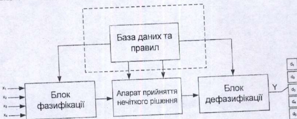
Рисунок 3 – Структурна схема блоку нечіткого логічного висновку системи керування ВЕУ з нечітким висновком про зміну заданої напруги
