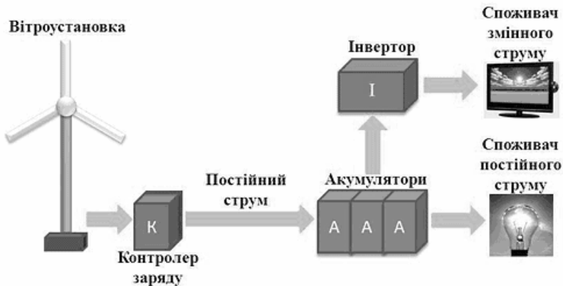
Рисунок 1.5 – Схема роботи вітроустановки
